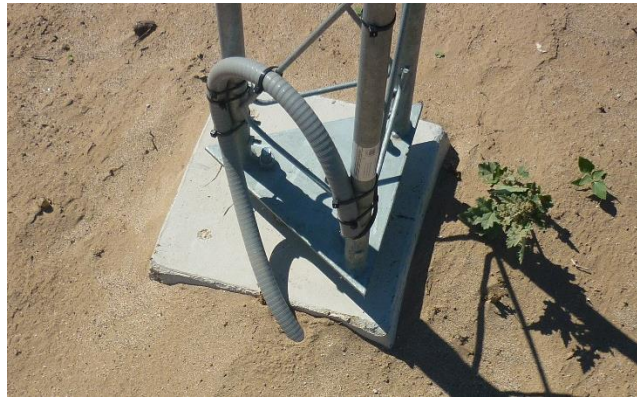
Figura 7. Fotografía de la parte visible del sensor de suelo (Hydraprobe). El sensor está bajo tierra y únicamente se ve el cable.
